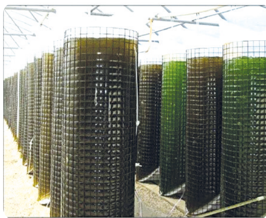
Рисунок 51. Пластиковые цилиндры (IFREMER, La Tremblade, отчёт 1997) и полиэтиленовые мешки, поддерживаемые армированными стойками [SRAC, 2013], для массового наращивания микроводорослей
