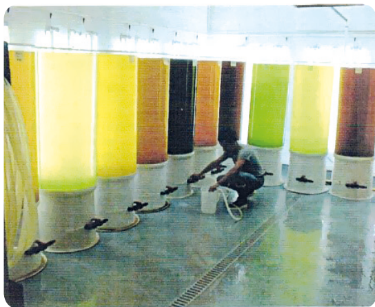
Рисунок 51. Пластиковые цилиндры (IFREMER, La Tremblade, отчёт 1997) и полиэтиленовые мешки, поддерживаемые армированными стойками [SRAC, 2013], для массового наращивания микроводорослей
