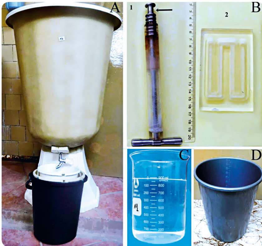
Рисунок 21. Оборудование, необходимое для обмена воды личинкам гигантской устрицы. А – расположение двух сит (сверху – с более крупной ячейкой); В1 – штемпель-пипетка для отбора проб личинок (стрелкой обозначен объём пробы в 1 мл); В2 – камера Богорова для подсчёта количества личинок; С – мерный стакан; D – градуированное ведро
