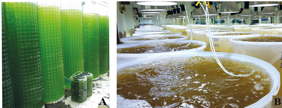
Рисунок 33. Культиваторы для микроводорослей, используемые в крупномасштабных питомниках [Sorgebous, 1996]
